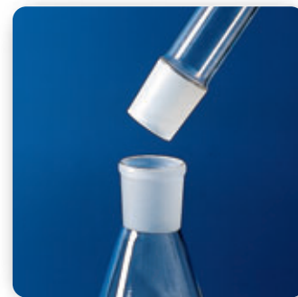
GUAINA PER CONI DI VETRO Materiale: PTFE Particolarmente studiate per proteggere i coni di vetro smerigliato dal bloccaggio. (Coni standard DIN 12242).
